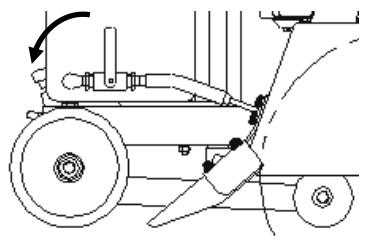
5. 昇降ハンドルを右（時計方向）に回し切削深さを決め、ストッパでロックします。
