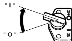
3. スピードコントロールレバーを低速位置から高速位置の方向に1/3位開いた位置にします。
