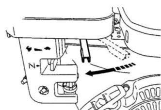
※本機の運転は必ずスピードコントロールレバーを高速位置で運転してください。
